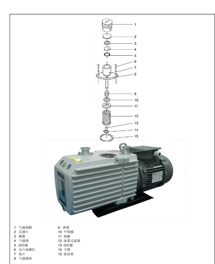
图5:油过滤器和气镇阀的分解图
