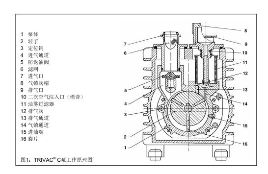
当泵停止时,泵轴上的离心开关开启放空管道,将大气空气送入防返油阀的活塞下,使防返油阀的阀盘压住进气口,将通向真空容器的管道封闭,将空气放入泵中。
