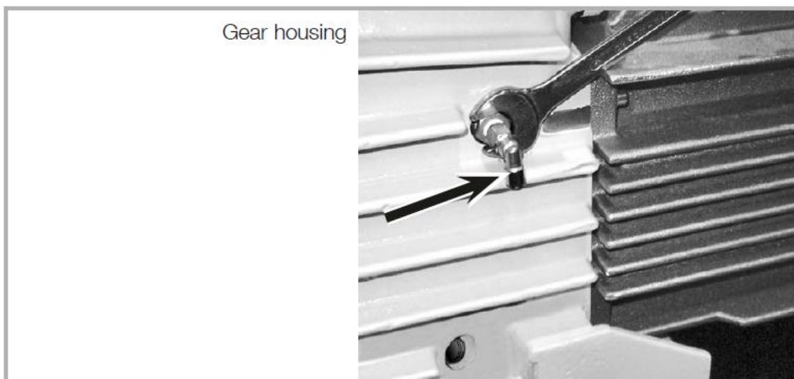
图 5.5 拧下两个节流阀
